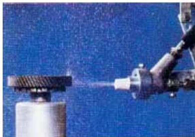
研磨材を高速度で吹き付けるサンドブラスト加工
